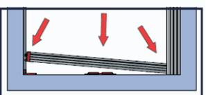
**6** Rimuovere il profilo magnetico della guida di chiusura e regolare la tensione dei fili agendo sul regolo scorrevole. Eventualmente per delle regolazioni più precise è possibile intervenire sui regoli posizionati nella guida laterale opposta; sono visibili spostando a mano la rete ed azionabili svitando la vite.
