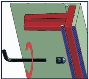
**2** Inserire gli agganci sulla guida inferiore in entrambi i lati, fissare a muro la guida con biadesivo e bloccare gli agganci in modo che aderiscano alla parete.
