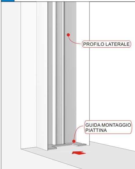
**5** Posizionare la piattina fra le due "guide montaggio piattina" e incollare al pavimento. N.B. Pulire preventivamente la superficie con un panno asciutto.
