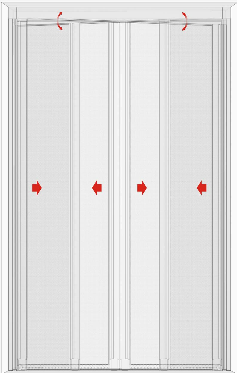
**1** Fissare il profilo portaguida superiore, completo di cuffie, nella parte alta del vano facendo attenzione che la cuffia mobile sia libera di compensare eventuali errori di misurazione.
