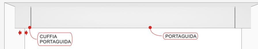
**2** Inserire il profilo laterale nella cuffia portaguida superiore e fissarlo al vano. Ripetere l'operazione anche sul lato opposto.
