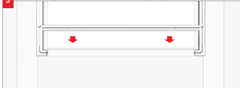
**6** Fissare la guida inferiore con le apposite viti e coprire i fori con i tappi.
