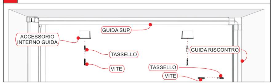
**8** Fissare la guida di riscontro, al centro e nella parte bassa, e inserire la guida inferiore nella cerniera.
