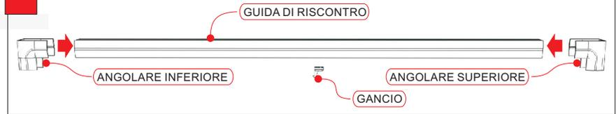
**7** Inserire la guida superiore nell'innesto della controtestata e fissarla usando l'accessorio interno guida. Fissare la guida di riscontro nella parte alta.
