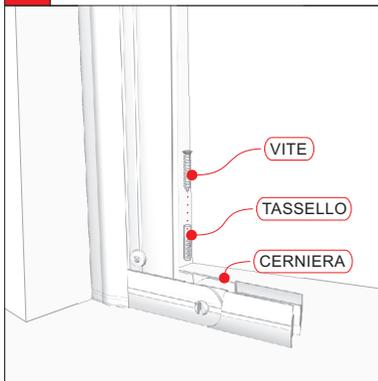
**7** Inserire le guide inferiori nelle cerniere, posizionare il gancio apertura centrale e fissarlo al pavimento.
