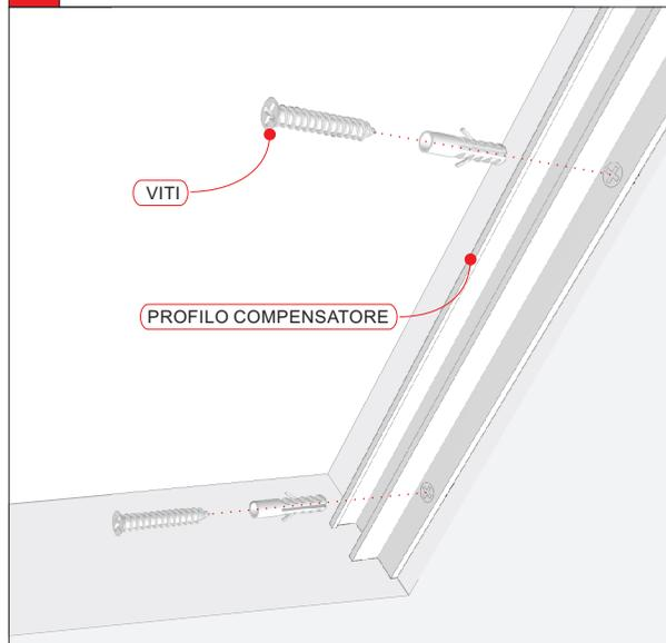
**5** Inserire il profilo compensatore in un lato del telaio.
