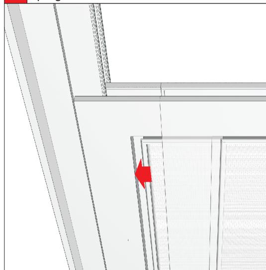
**7** Fissare il profilo compensatore laterale. Regolare il telaio nella posizione desiderata e bloccarlo con le apposite viti.
