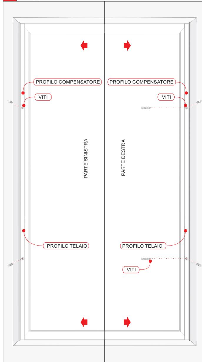
**9** Zanzariera completa. Una volta installata la zanzariera, fissare le maniglie.
