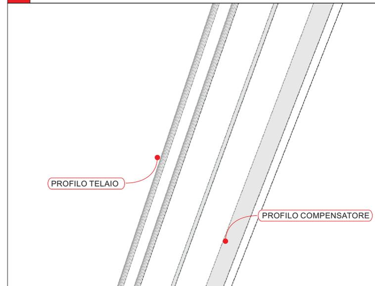
**6** Inserire il telaio precedentemente montato con il profilo compensatore sul lato, nel profilo compensatore installato nel vano.
