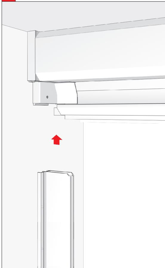
**6** Fissare le guide e le scarpette al vano, con le apposite viti.
