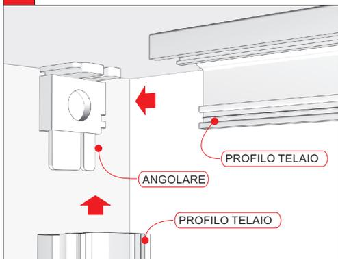
**2** Fissare il telaio al vano con le apposite viti.
