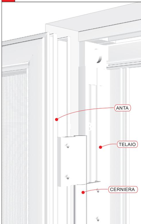
**5** Forare il pavimento ed il telaio superiore per bloccare l'anta fissa con i catenaccioli.
