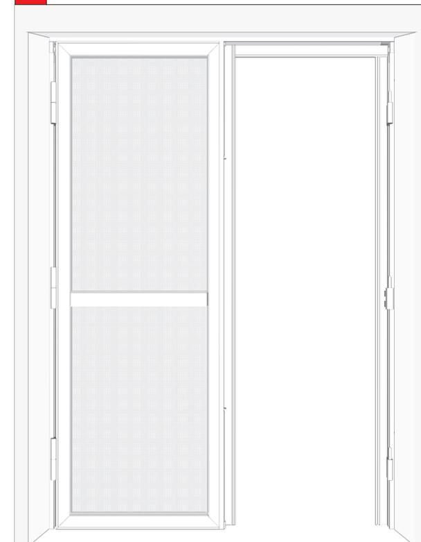
**7** Regolare la forza della molla di richiamo con una chiave esagonale da 4 mm, ruotando nel verso di apertura dell'anta.
