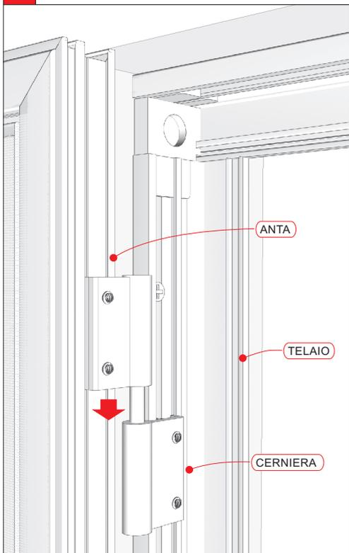
**4** Regolare le cerniere, se necessario, svitando le brugole di uno dei due componenti delle stesse.
