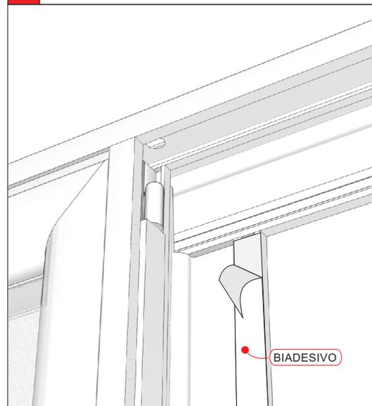
**11** Chiudere l'anta facendo pressione sulla parte centrale, in modo da far aderire il magnete adesivo sul profilo di alluminio.
