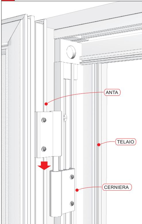
**4** Regolare le cerniere, se necessario, svitando le brugole di uno dei due componenti delle stesse. Ripetere l'operazione anche sulla 4° anta.
