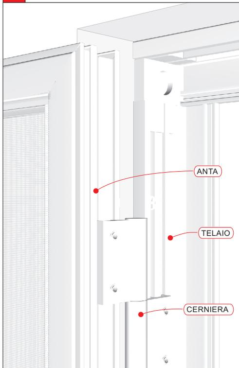
**5** Inserire la seconda anta nelle cerniere. Regolare le cerniere, se necessario, svitando le brugole di uno dei due componenti delle stesse. Ripetere l'operazione anche sulla 3° anta.
